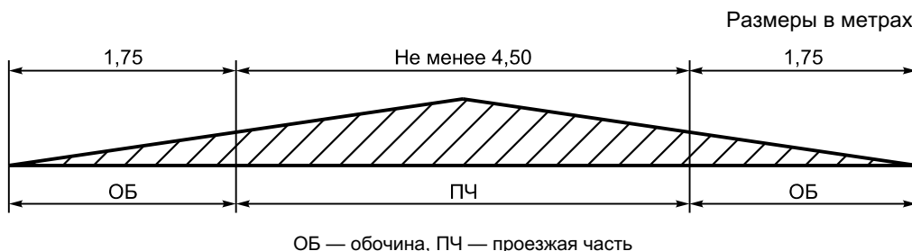
Рисунок 12 — Поперечные профили автомобильных дорог категории V
