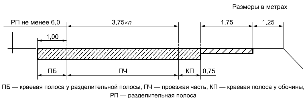
Рисунок 2 — Поперечные профили автомобильных дорог категорий IA, IB без ограждений
